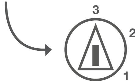
Unsere Gorilla Rattenfallen sind auf der Unterseite mit einem Sensibilitätsensor ausgestattet. Sollte die Falle zu schnell auslösen, stellen Sie den Regler auf Position 3 (siehe Abbildung).
